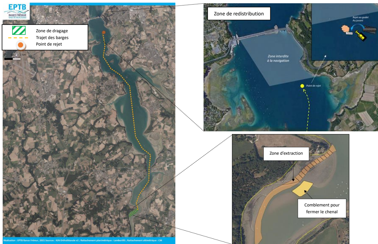
Figure 1 : Organisation prévisionnelle du chantier d'extraction des sédiments
